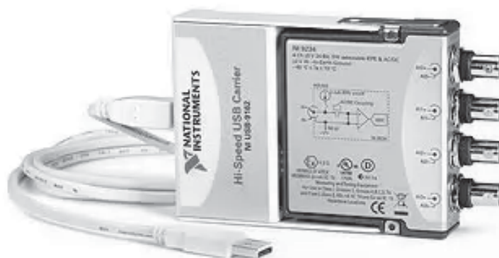
Rys. 4. Karta pomiarowa NI USB-9162 NI9233
